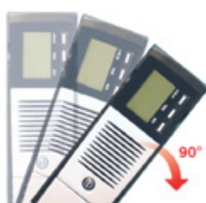
3. Повернуть ИБП на 90°
